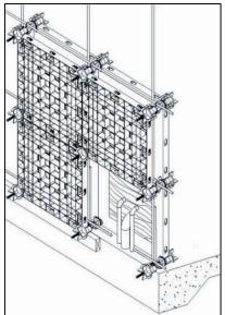
Esquinas de acero: Las esquinas están hechas de acero de calibre 14 con un ángulo ajustable para recibir el soporte de anclaje.
